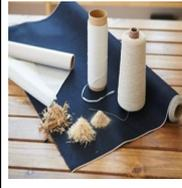
世界最大の農作物であるさとうきびを原材料に、サステナブルな繊維や生地へとアップサイクルすることが、世界規模で重要な取り組みになると可能性を感じ、さとうきびの搾りかすで、未利用資源である「バガス」を原材料とした素材を開発。日本の伝統的なものづくりの技術を独自に掛け合わせ、バガスからパウダー化、和紙、スリットの工程を経て和紙糸を生成し、その和紙糸とcotton USAで生地を織布している。
