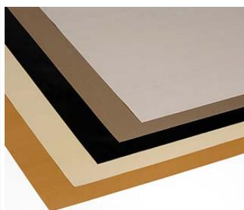
フッ素樹脂ファブリックは基材のガラスクロスを選定することにより45ミクロン～1mm近くまで様々な厚みを実現。耐熱性、非粘着性、滑り性、耐薬品性、耐候性、絶縁性、寸法安定性といった特性を兼ね備えていて、伸縮はしないが柔らかくカッターナイフで容易にカットができる。コーティングするフッ素樹脂の種類を変えることで厚さをミクロン単位で制御できるため、屋根膜材やクッキングシート、粘着テープ、コンベアベルト、銅張積層基板、ラミネート板など様々な用途の製品に応用されている。基材をアラミド繊維クロスに変えることにより折り曲げにも強いタフなファブリックにもなる。
