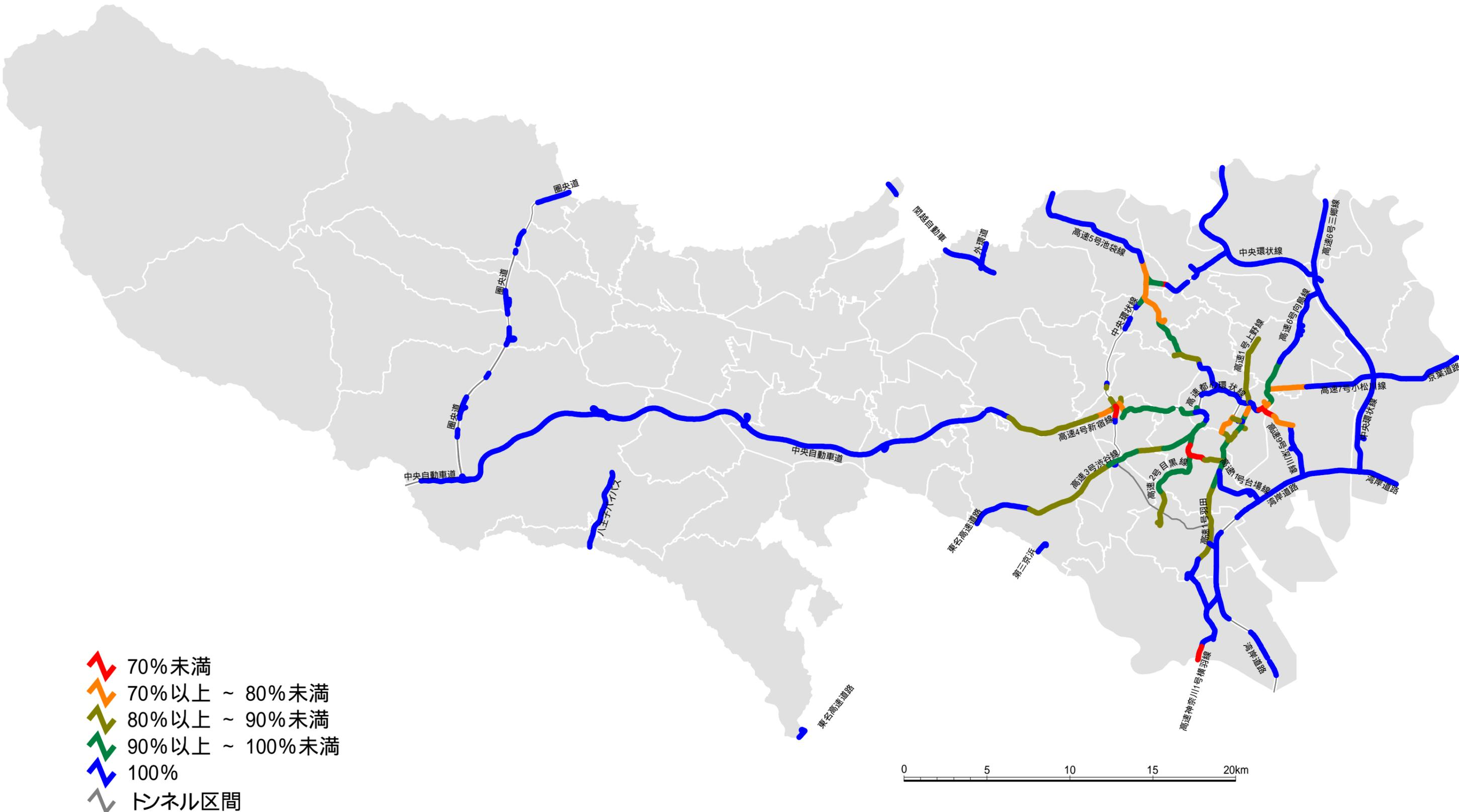
特定緊急輸送道路沿道建築物の耐震化状況(令和元年6月末時点)[高速道路]
