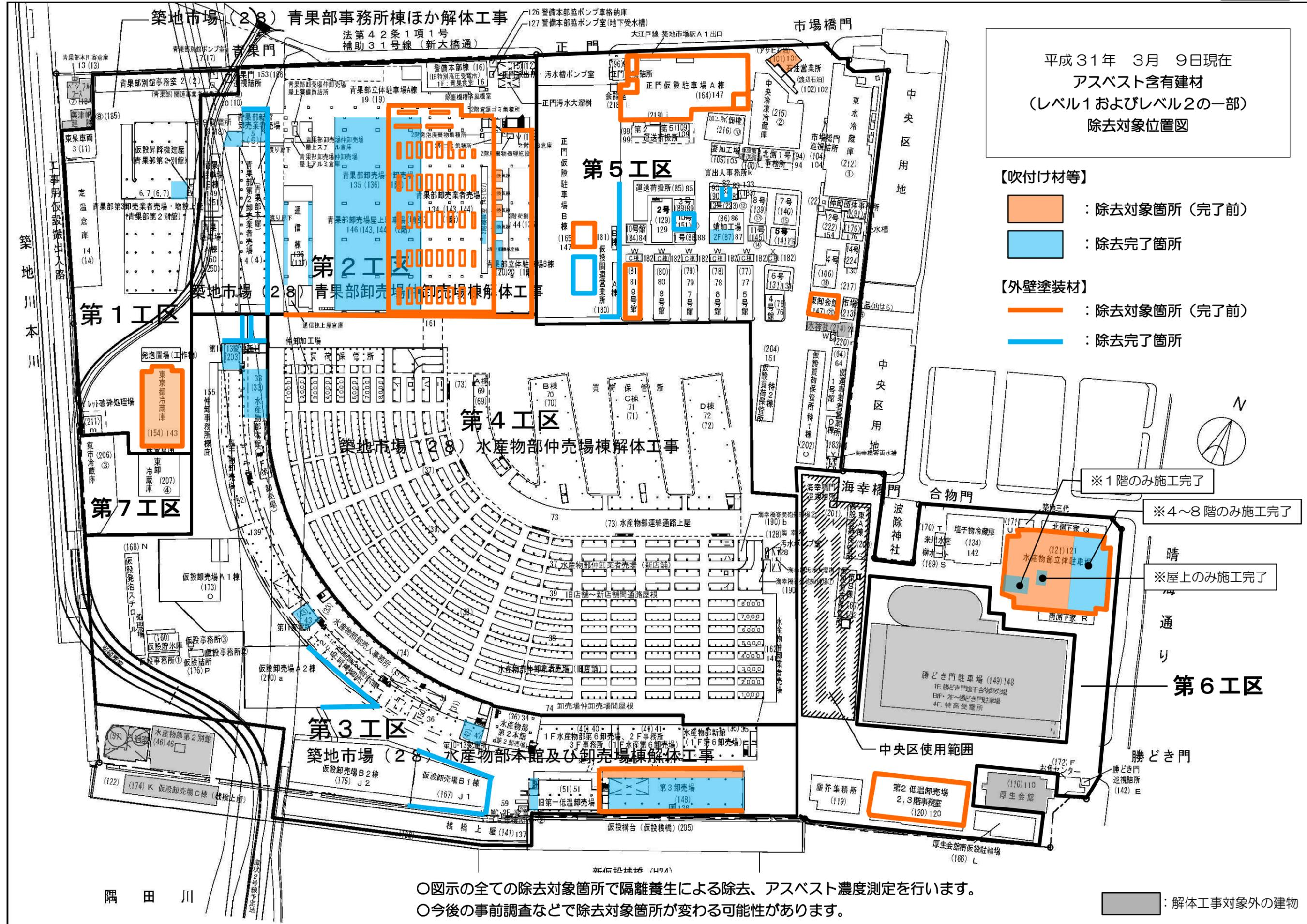
○図示の全ての除去対象箇所にて隔離養生による除去、アスベスト濃度測定を行います。
