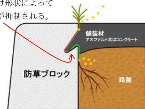
イラスト-1 成長特性と逆向きとなる形状 (黄点：宿根や種子)
