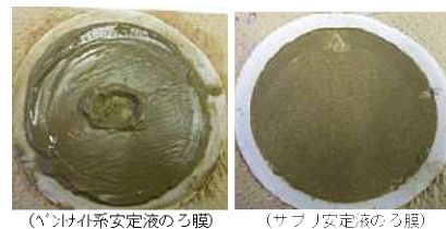
写真-1 各安定液で形成された泥膜
