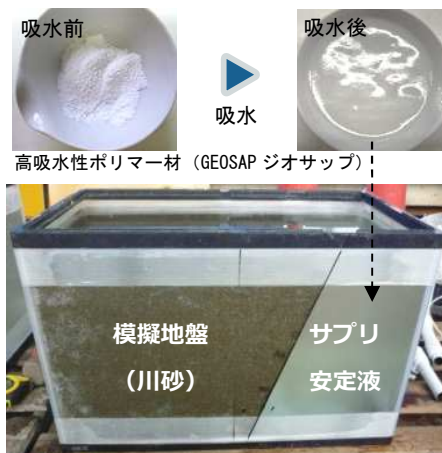
サプリー安定液の孔壁安定性 (掘底杭を模擬した試験)
