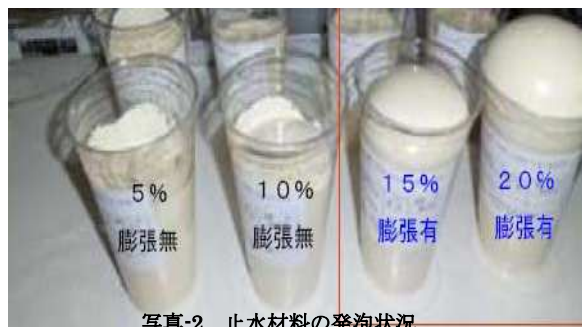
写真-2 止水材料の発泡状況
