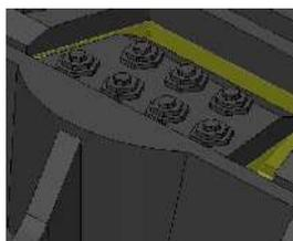
図-4 耐スリップ構造
