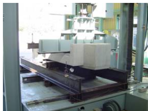
写真2 鉛直載荷実験
