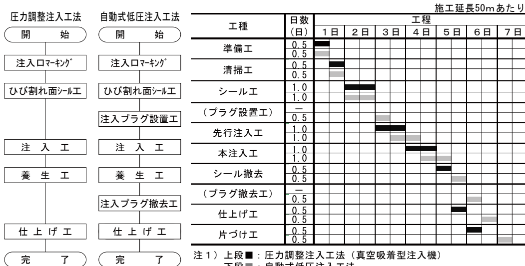
図-3 施工手順の比較
