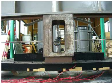
変位測定 荷重: 58.3kN 変位: 4.64mm
