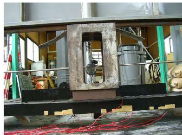
残留たわみ測定 残留たわみ: 0.1mm
