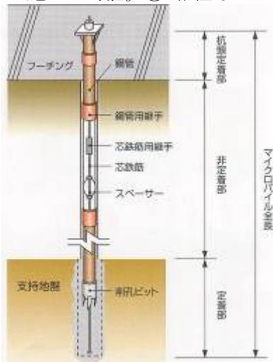
図-1 高耐力マイクロパイルの概念
