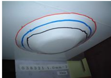
タフガードQ-R工法の押抜き試験状況
