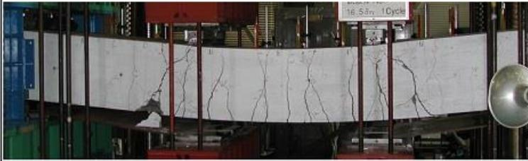
梁の曲げ試験の破壊状況(半円形フック)
