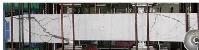
(d) Tヘッド工法鉄筋(主鉄筋間配置)
