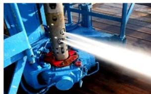
扇形改良(1方向3ノズル喷射)
