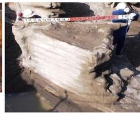
図-3 野外造成実験(改良体形状 噴射揺動角度 45°)
