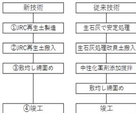
図-1 新技術と従来技術の施工フロー
