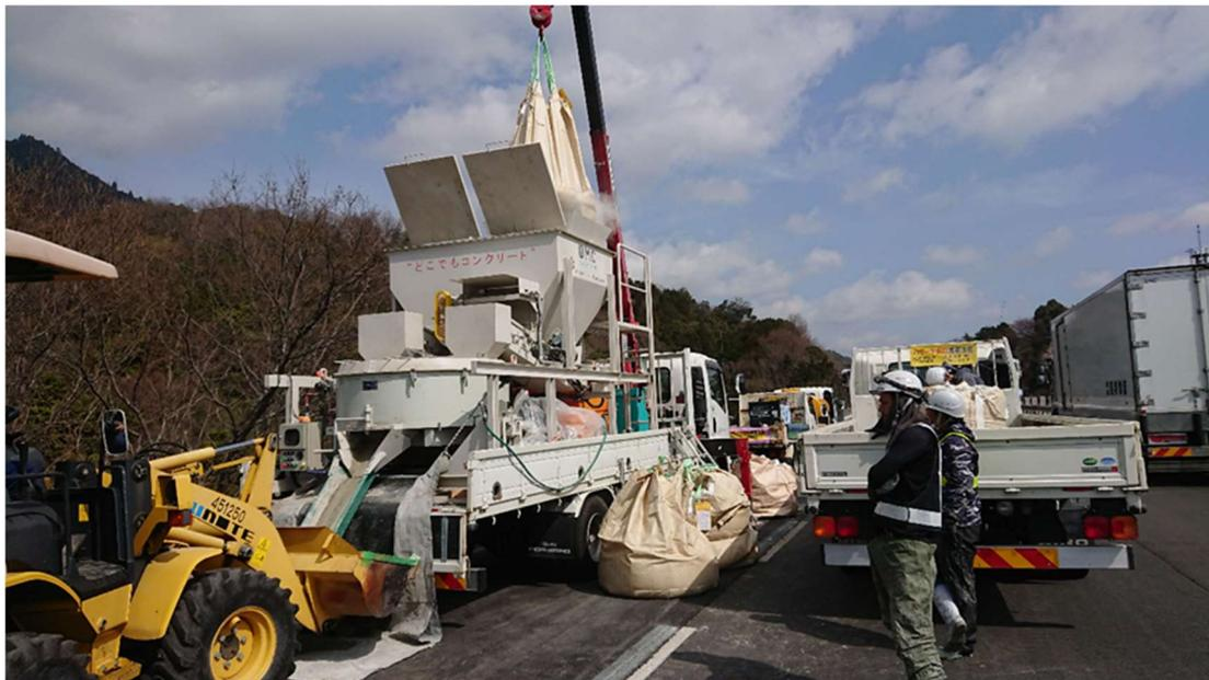
写真-1 中型車両に搭載した DMC-12 (V)号機
