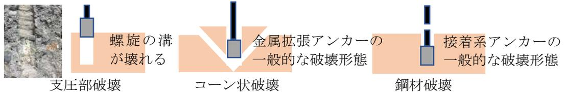
図-4 アンカーの破壊形態
