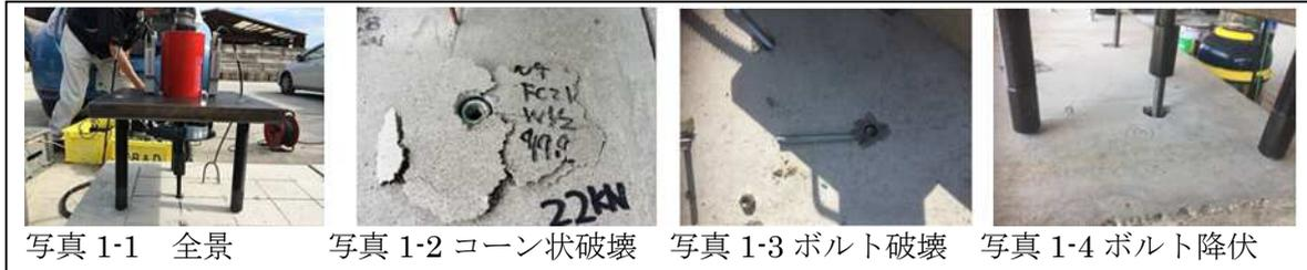
写真 1-1 全景      写真 1-2 コーン状破壊      写真 1-3 ボルト破壊      写真 1-4 ボルト降伏
