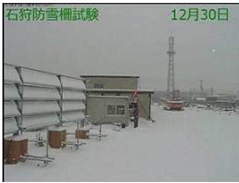
写真-2 実大防雪柵暴露試験
